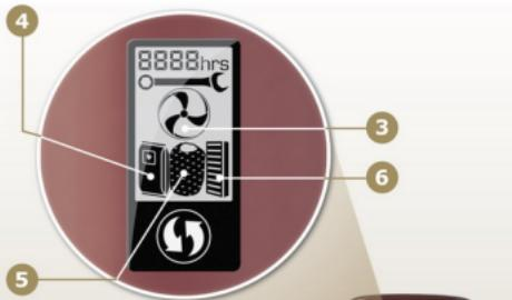
Сигнал индикатора «МЕШОК» (4) (для серии GX) – проверить/сменить мешок.
